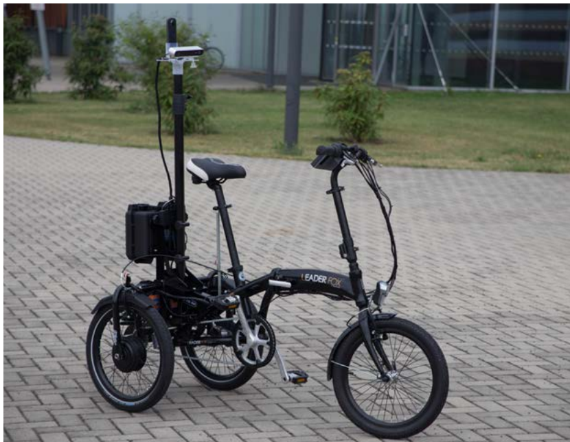
Mapovací vozítko sbírá data z chodníků a stezek, kam se nedostanou mapovací auta
