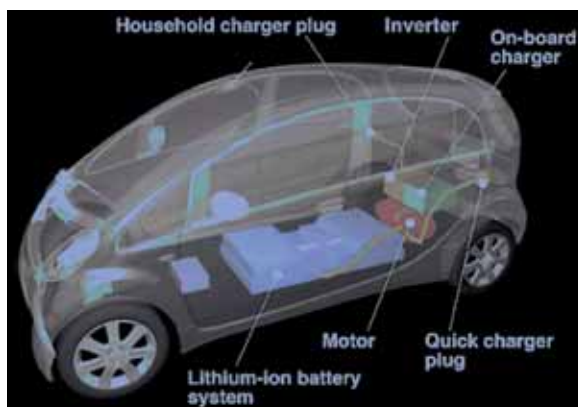
Základní moduly elektrického vozidla řešené v projektu E3Car
