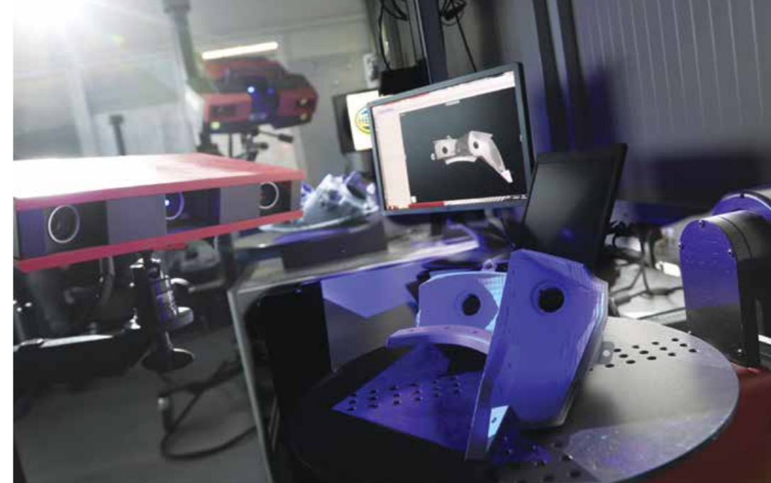
3D optické měření reflektorů. Každý vyrobený díl i smontovaný světlomet prochází ve fázi vývoje rozměrovou kontrolou.
