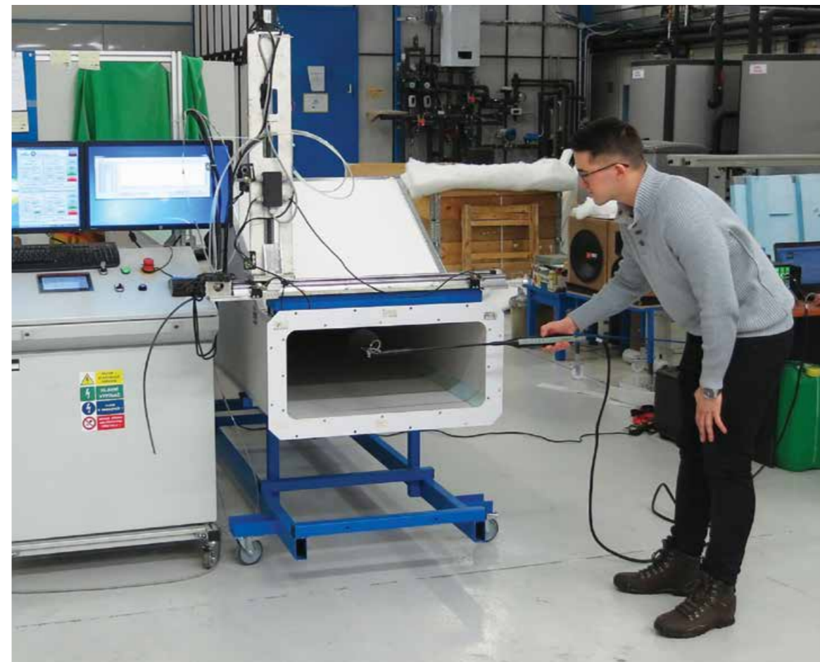
Zkušební tunel pro aerodynamické buzení akustického tlumiče
