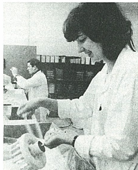
Záběr z laboratoře katedry slévárenství strojní fakulty VUT - výroba voskových modelů pro přesné lití turbinových lopatek
