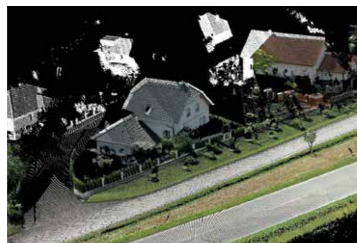
Laserové mračno získané díky skenerům na vozidle.
