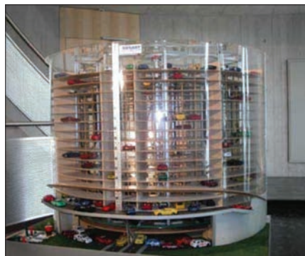
Model systému využívajícího simultánní pohyb – jeden ve svislé rovině a dva ve vodorovné úrovni
