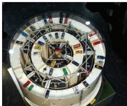
Model systému využívajícího simultánní pohyb – jeden ve svislé rovině a dva ve vodorovné úrovni
