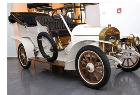
Automobil Laurin & Klement GR4, vyrobený kolem roku 1909 s originální karoserií phaeton Roi des Belges .
