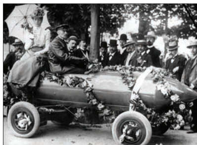
Jenatzyův „automobilní vůz“, elektromobil La Jamais contente , jehož kovové části jsou zhotoveny z partinia*. Partinium byla slitina hliníku a wolframu (Henry Partino) s měrnou hmotností 2,89. Korba vozidla byla tudíž velmi lehká, měla 50–60% hmotnosti kostry dřevěné.
