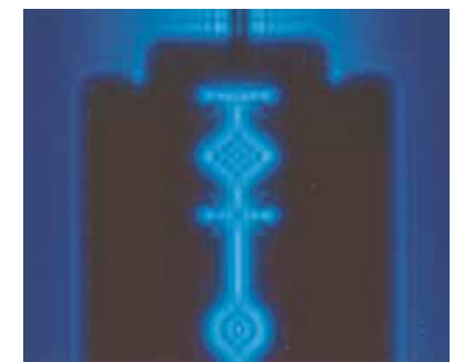
OBR. 36-2 Difrakce monochromatického světla na žiletce. Všimněte si maxim a minim intenzity.
