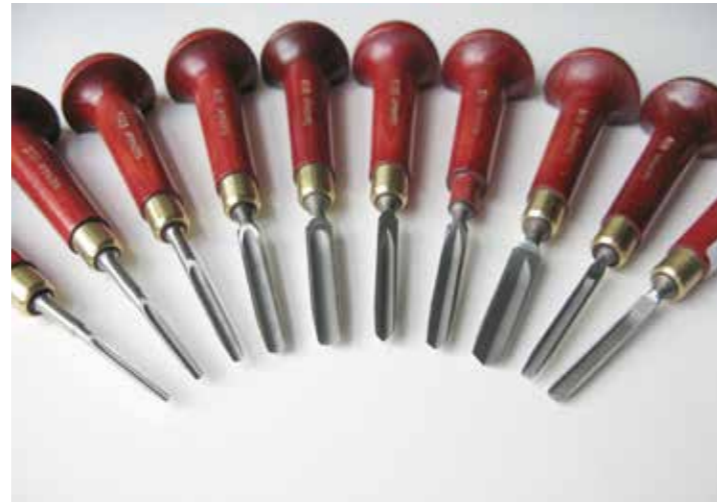
75 nahoře Různé typy barvicích válečků (pryž, polyuretan) a barvicí tampon 76 uprostřed Rydla pro dřevoryt 77 dole Dláta pro dřevořez a dřevoryt
