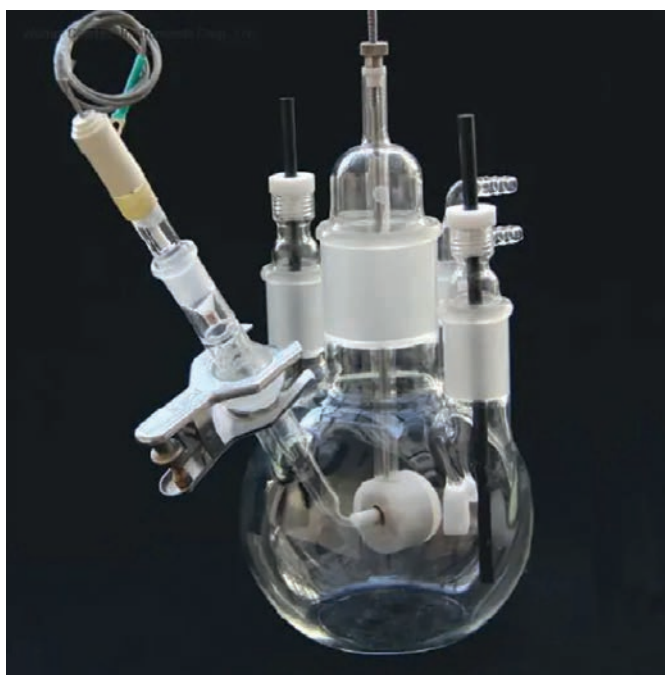
Obrázek 13.14 Měřicí cely pro polarizační měření (tříelektrodový set).
