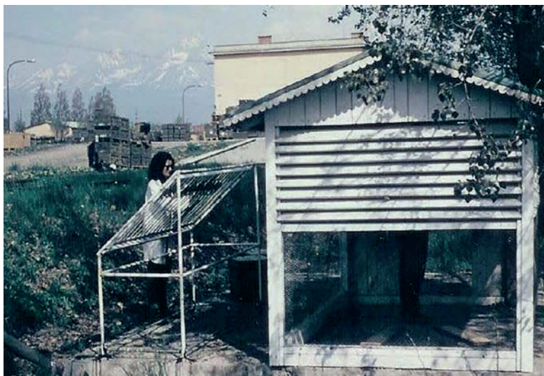
Obrázek 13.12 Staniční zkoušky ve venkovní atmosféře a zkušebním přístřešku.
