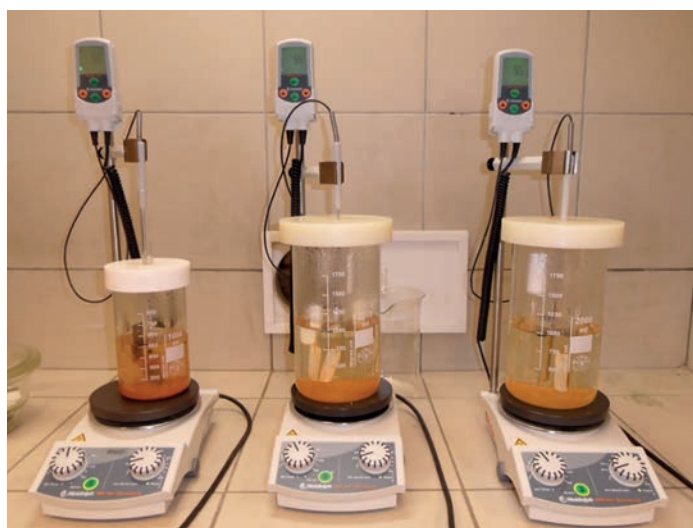
Obrázek 13.7 Set zkušebních zařízení pro testování korozní odolnosti materiálů podle OECD.
