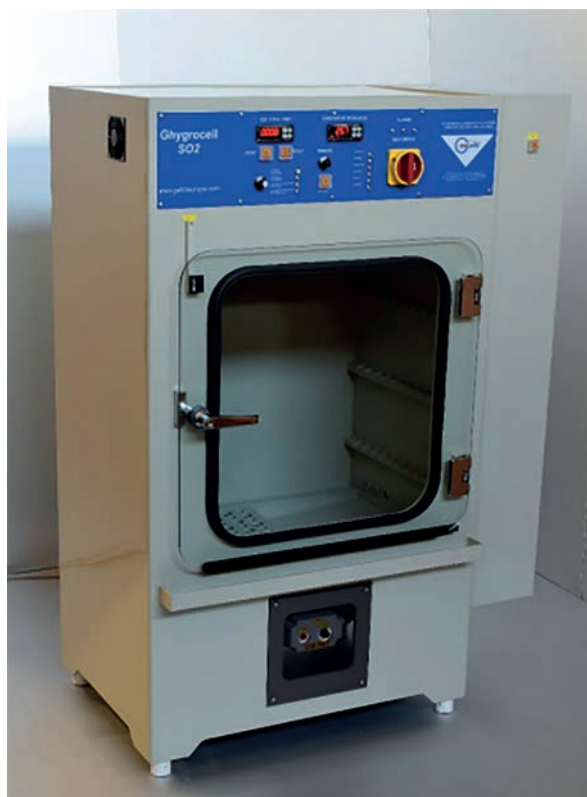
Obrázek 13.6 Zařízení pro zkoušku podle Kesternicha, typ GHygrocellSO2.
