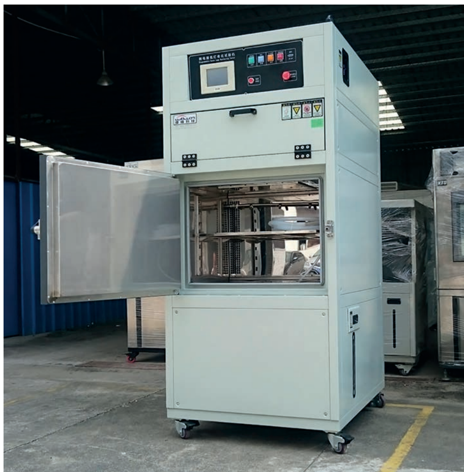
Obrázek 13.11 Zkušební zařízení typu weatherometer Wewon pro vícefázové zkoušky.
