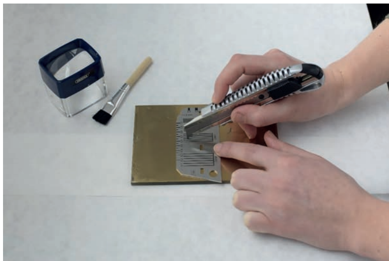
Obrázek 13.18 Stanovení přilnavosti povlaku řezem mřížky šablonou Elcometer F100.
