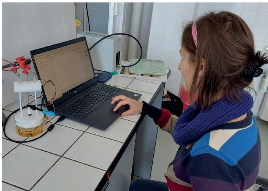
Obrázek 13.13 Polarizační měření pomocí potenciostatu Metrohm Autolab PGSTAT.
