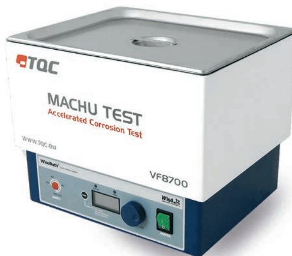
Obrázek 13.8 Zařízení pro Machu zkoušku (typ TQC).
