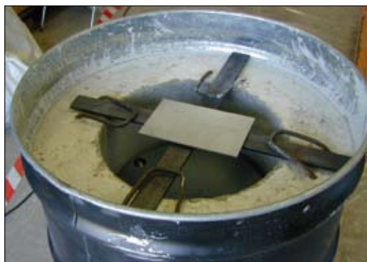
Obr. 14-2. Sud vybavený stíněním z betonu pro uložení Ra-226
