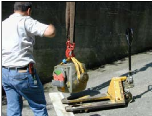
Obr. 8-9. Nakládka pouzdra s použitým zářičem
