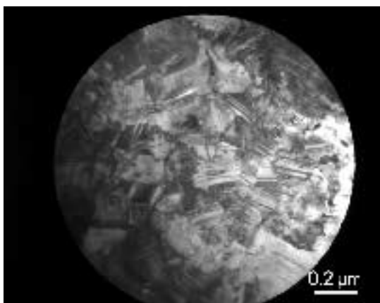
Obr.14 TEM, světlé pole, Ni-SiO 2 , 53 000x
