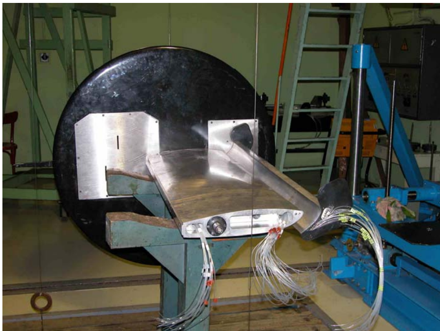
Obr. 4.2 Pohled na experimentální model křídla, slotu a koncové desky pro tlaková měření.
