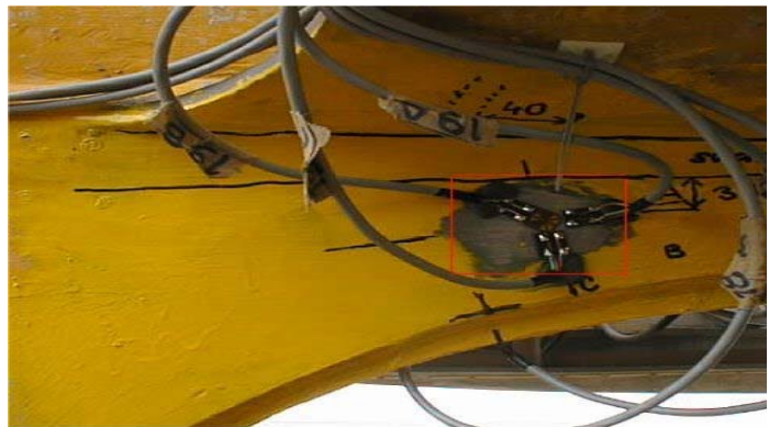
Obr.5.6. Příčný nosník, růžice G19a,b,c
