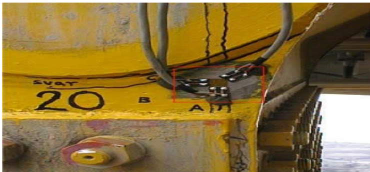
Obr.5.7. Příčný nosník, růžice G20a,b,c
