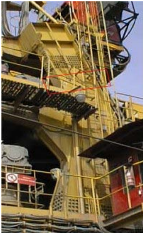
Obr.5.5. Úzký sloup, tenzometry G16a,b,c,d
