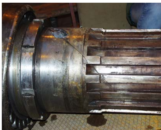
Obr.5.10. Trhlina v hřídeli kolesového rypadla K 650/3
