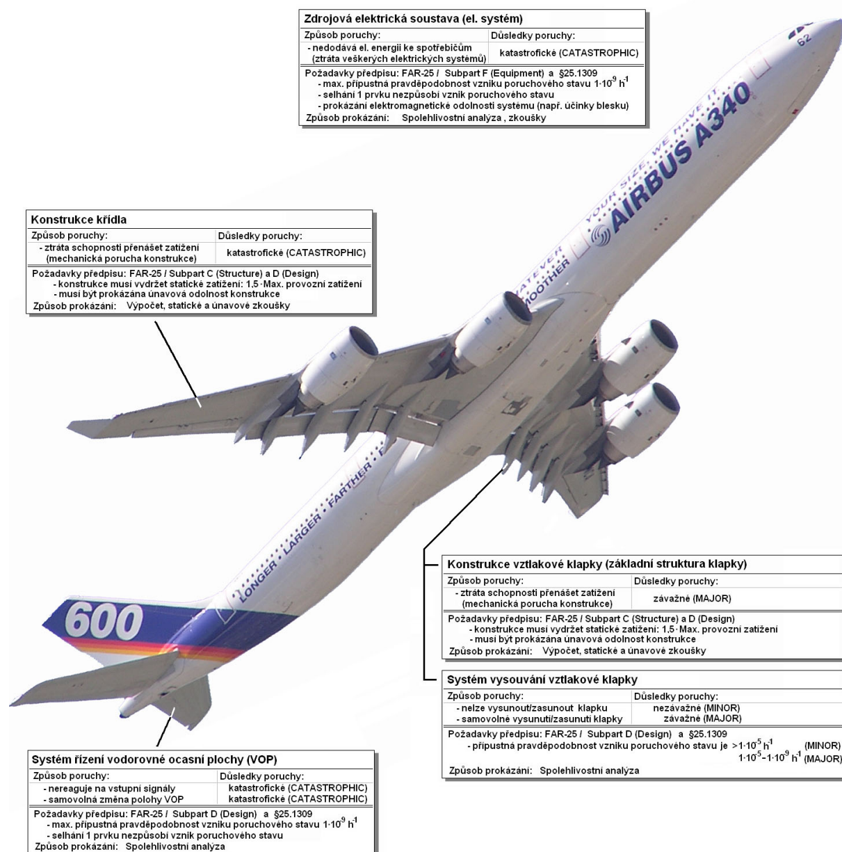
Obr. 2: Zjednodušený souhrn požadavků na jednotlivé části letounu
