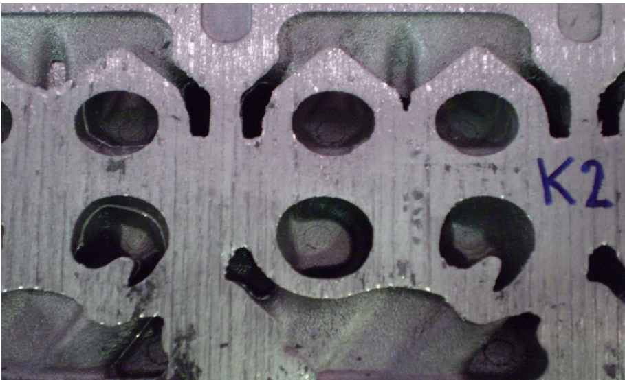
Obr. 5: otvory v odlitku vytvořené jádrem s pojivem KOŽNÍ KLIH K-2
