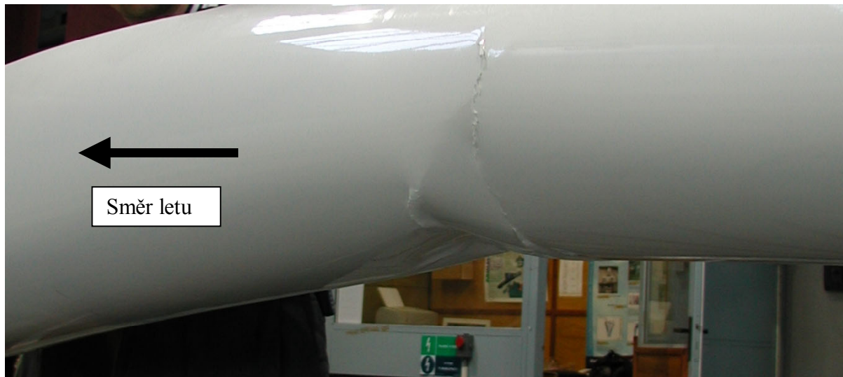
Obr. 6.3 Porucha kompozitního trupu letounu TST-10 Atlas
