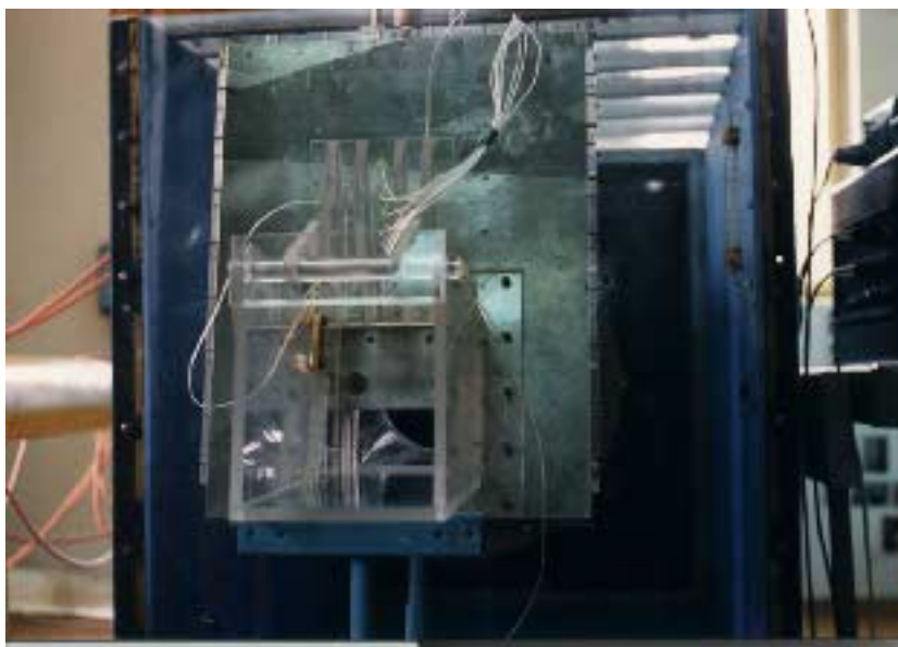
Obr. 19 Stanovení přitěžovacích sil a tlakových poměrů na uzávěrech spodní výpusti VD Marun v Iránské republice – výzkum na aerodynamickém modelu se snímáním tlaků v charakteristických bodech
