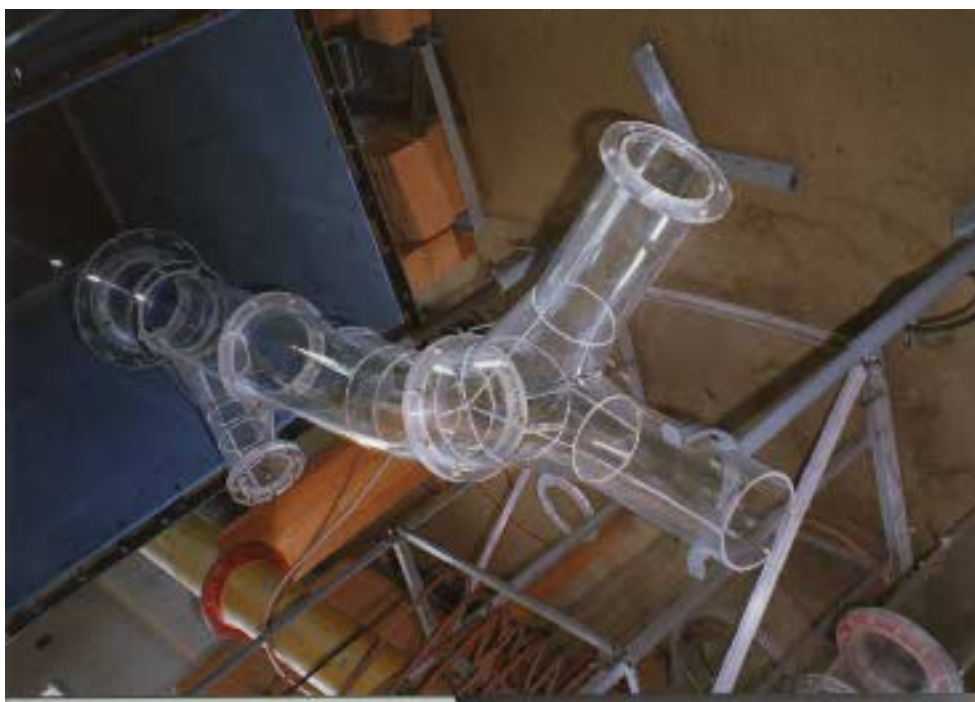
Obr. 18 Výzkum proudových poměrů v systému odbočnic na odtoku z VD Marun v Iránské republice – aerodynamický model
