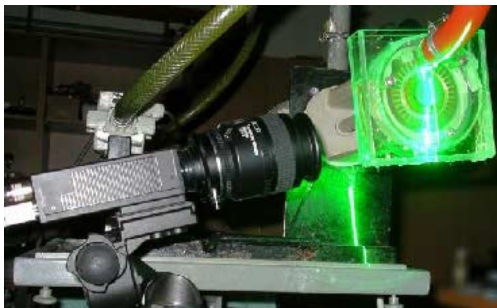
Obr. 10 Osvětlování měrné roviny kolmé na disk oběžného kola čerpadla, detail rychlostního pole na obr. 9
