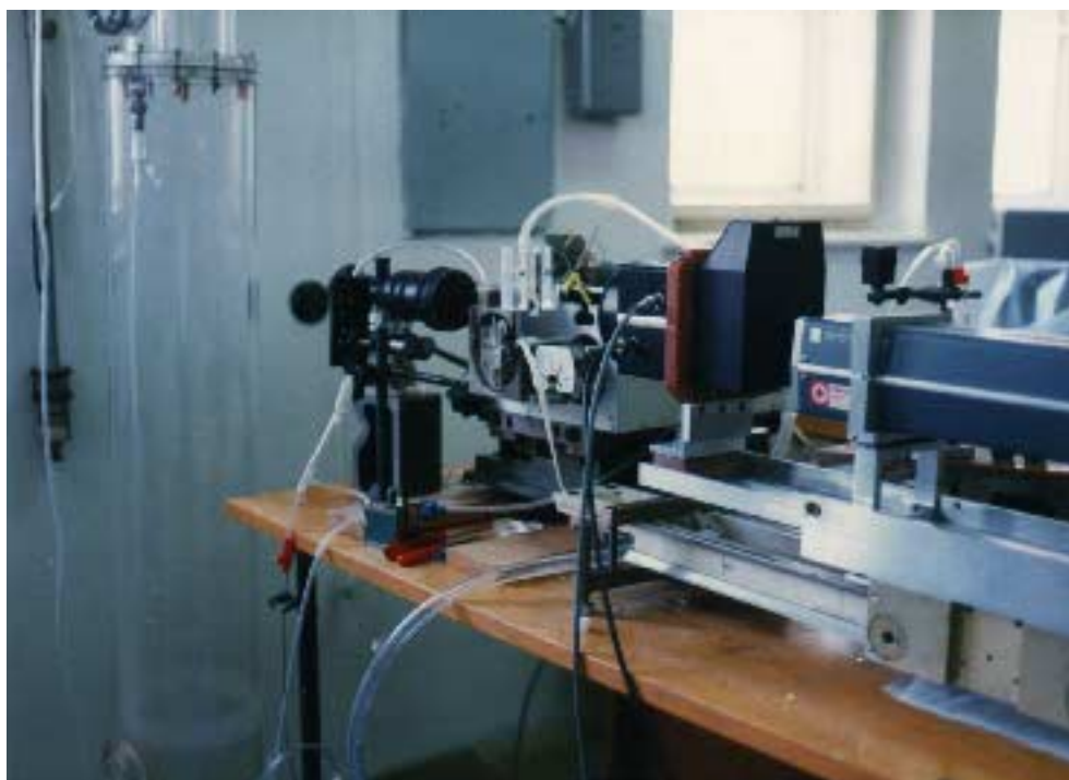
Obr. 7 Měření časového vývoje rychlostního pole za výstupem z čerpadla pro umělý krevní oběh (dialýzu) laserovým dopplerovským anemometrem
