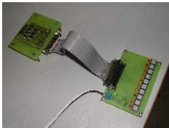
Obr. 38. Přípravek pro zkoušku radiační odolnosti PIC
