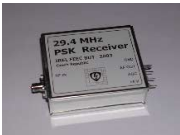
Obr. 31. Přijímač satelitního transpondéru PCSAT2 vyvinutý na VUT v Brně pro US Naval Academy
