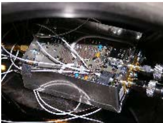
Obr. 37. TV zkouška prototypu syntezátoru
