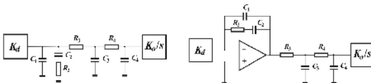
Obr. 27. Typické konfigurace filtrů fázového závěsu (pasivní a aktivní)
