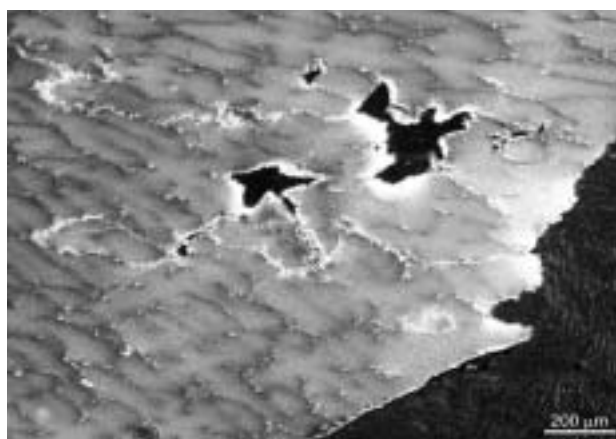
Obr. 9 Magistrální trhlina a kavity vz. 15 (SM)
