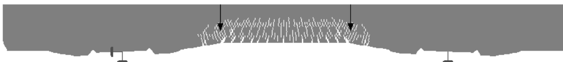
Obr. 12.1 Ilustrace nelineárního MKP modelu zkoušky čtyřbodového ohybu pražce (ATENA)
