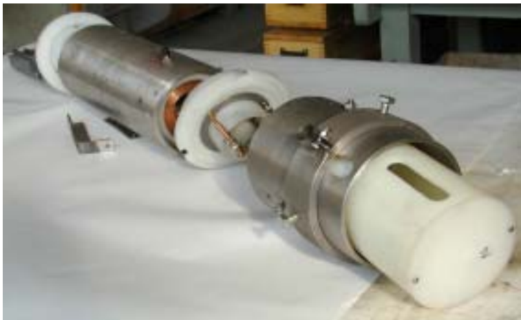
Obr. 6.2 Sestava pulsního generátoru PGV-1 před konečnou montáží
