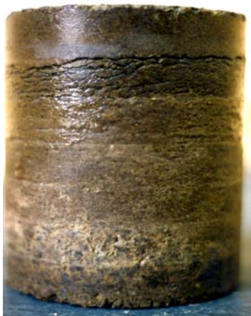
Obr. 4 – Zkušební těleso po zkoušce namrzavosti
