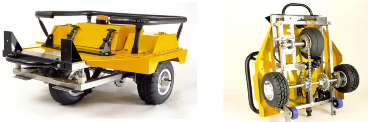
Obr. 12 – Měření protismykových vlastností (Griptester firmy CONSULTEST s.r.o.)
