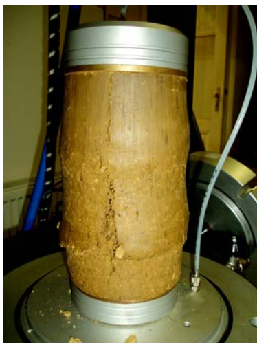
Obr. 3 – Zkušební těleso po zkoušce opakování zatěžování v triaxiálním tlaku
