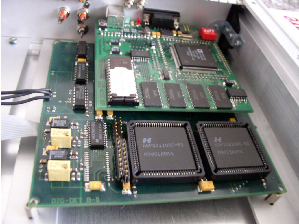
Obr. 4.19. Fotografie realizované digitální části demodulátoru SATCOM.
