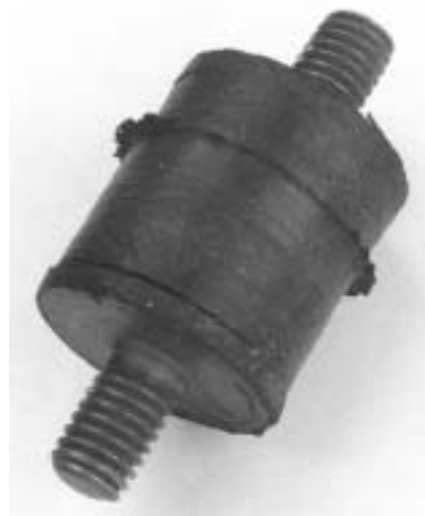
obr. 6 : Vzorek použitý pro krutovou zkoušku adheze pryž-ocel
