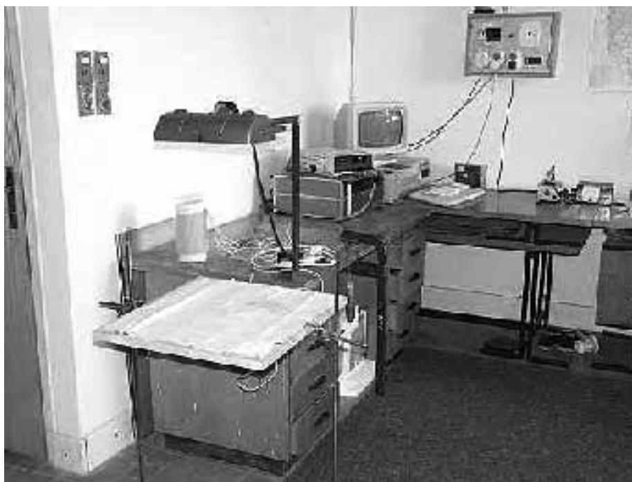
Obr. 15. Pracovisko na monitorovanie teplotných polí v tomto konkrétnom prípade je monitorovaná čalunnícka skladba študovaná v rámci PhD dizertácie.
