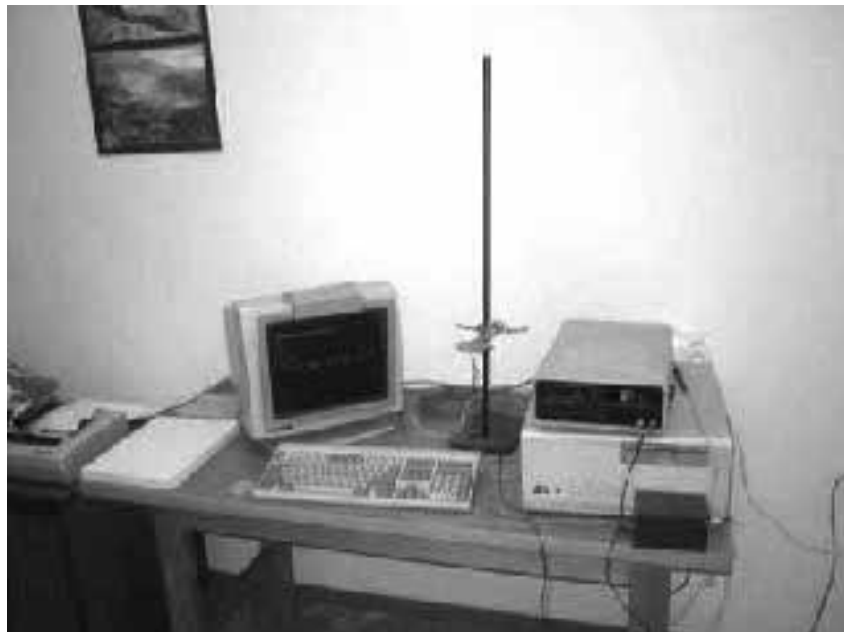
Obr. 4. Experiment na určenie koeficienta tepelnej a teplotnej vodivosti materiálu pulznou metódou.
