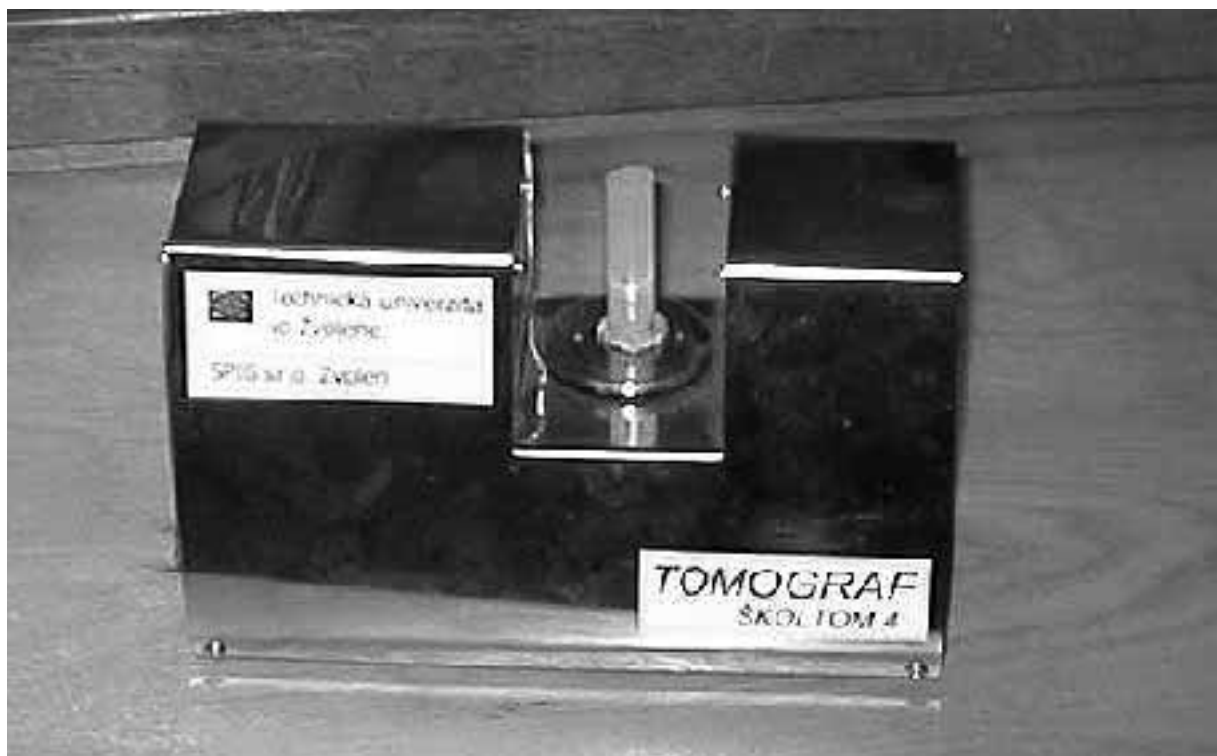
Obr. 10. Tomograf PRMDT-04 „ŠKOLTOM“, ktorý pracuje vo viditeľnom svetle. Slúži výuke zobrazovacích a rekonštrukčných metód.
