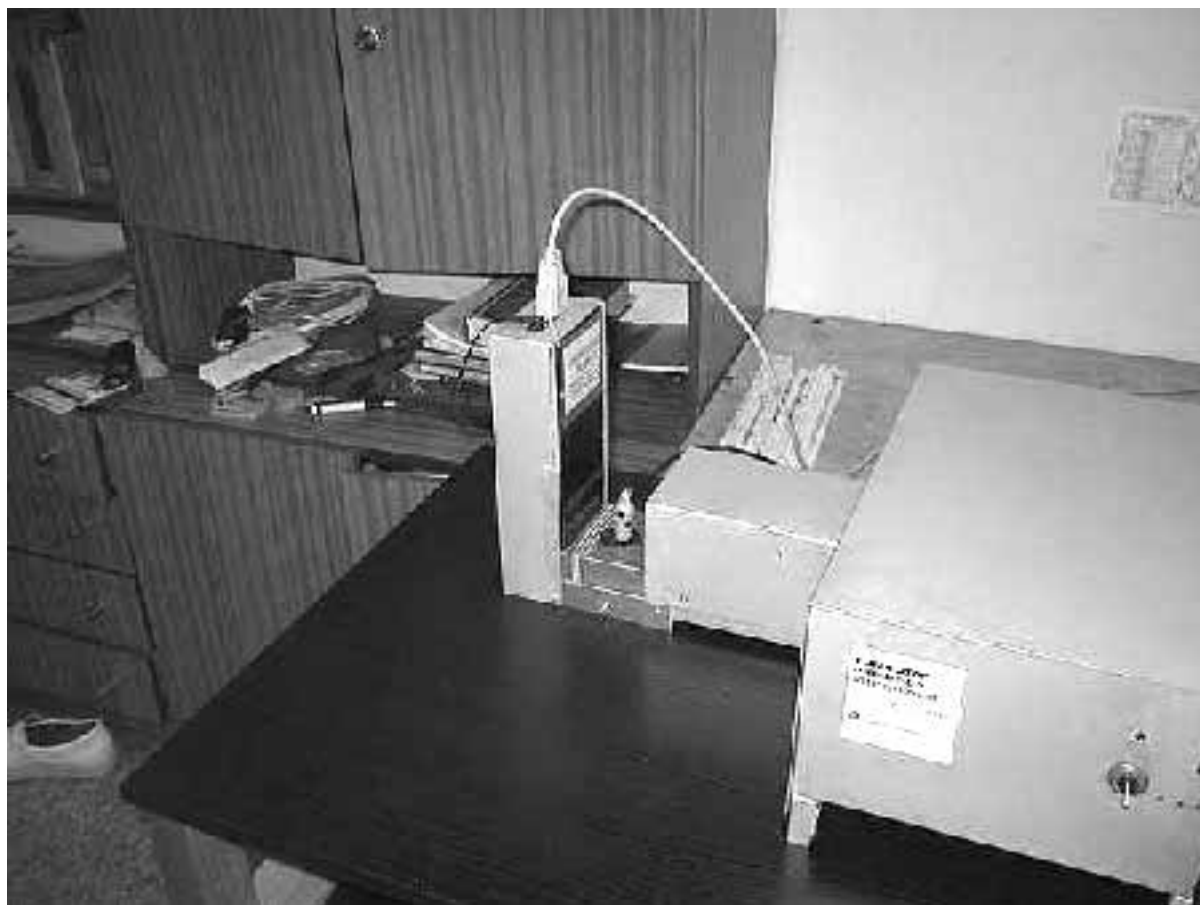
Obr. 9. Tomograf PRMDT-03 „MIKROTOM“ vybavený 64 kanálovým detekčným systémom Hamamatsu a Rentgenkou Blue Box Instruments. Jeho ochrana pred ionizujúcim žiarením je vyriešená tak, že je certifikovaný pre prácu v bežnom laboratóriu.
