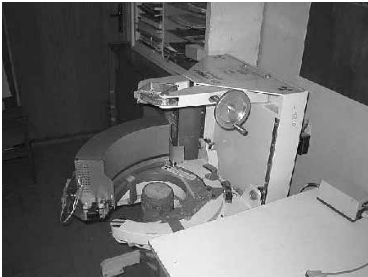
Obr. 8. Tomograf PRMDT-02 „ŠKOLTOM“ v tomto prípade s detekčnou hlavou 512 kanálového systému Hamamatsu pre snímanie v geometrii vejárových lúčov.
