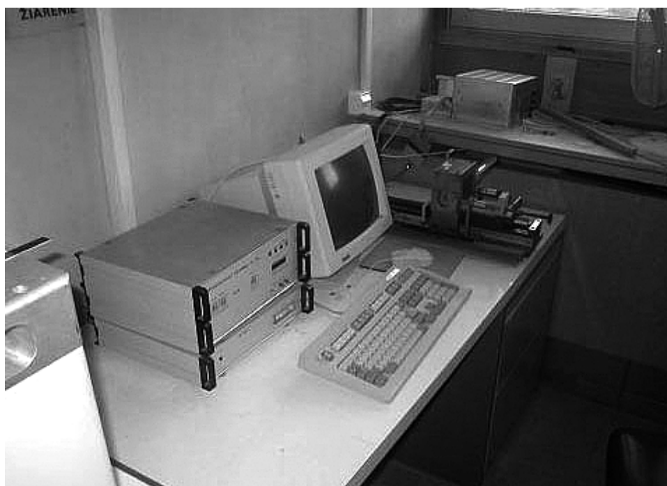
Obr. 7. Integrovaný hustomer IH 10, riadiaci počítač a automatizované meracie zariadenie zabezpečujúce nastavovanie kolimačných štrbín a polohovanie vzorky s presnosťou 0.001 mm..
