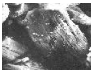
Obr. 9: Xenomorfní zrna \beta -sádry připravené dehydratací za teploty 150°C a za normálního atmosférického tlaku, zvětšení 2000x
