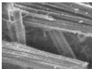
Obr. 10: Hypautomorfni zrna \alpha -sádry připravené v autoklávu dehydratačním režimem 135°C/8 hod bez mineralizátoru, zvětšení 2000x
