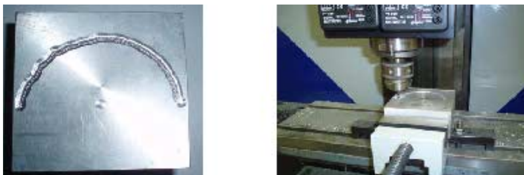
Obrázek 11: Výroba výsledného válce na frézce
