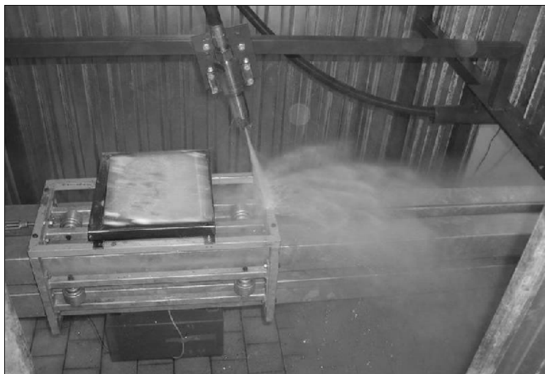
Obr. 11: Průběh experimentu, deska o teplotě 950 °C s připravenými sekundárními okujemi projíždí rychlostí 1 m/s pod tryskou
