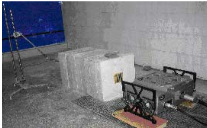
Obr. 4 Snímkování vrstvy betonu o tloušťce 1 m ve Výzkumném ústavu introskopie betatronem MIB-7,5
