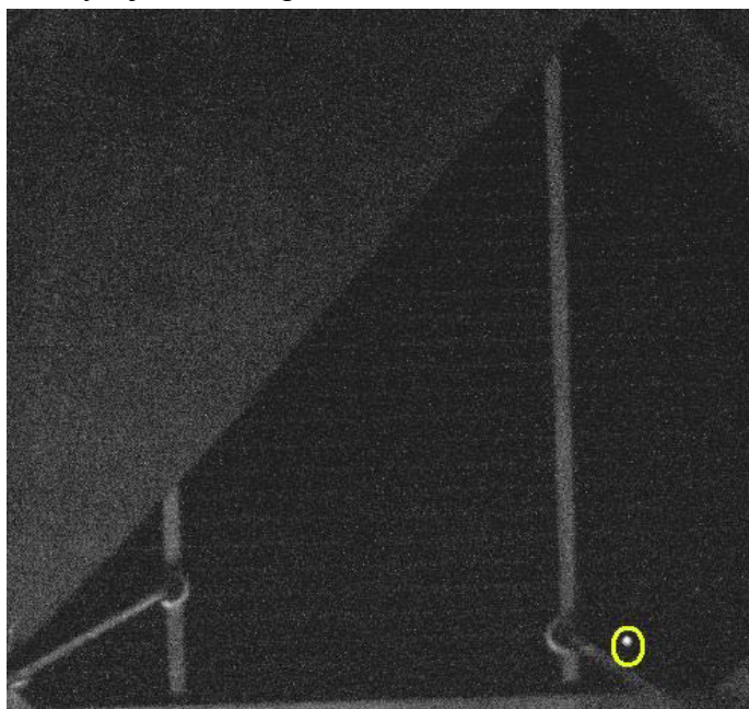
Obr. 4.5 Emise světla z mikroplazmy, první zaznamenaný bod ( U_R = 5\text{ V} , t = 21\text{ °C} , t_{\text{CCD}} = -20\text{ °C} )
