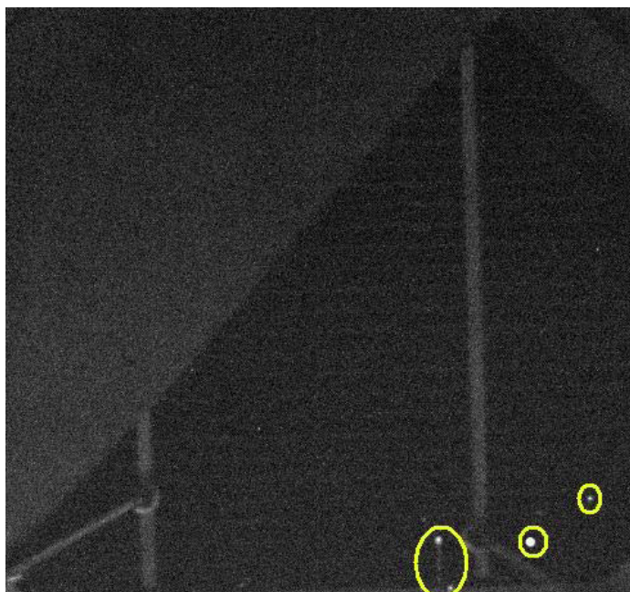
Obr. 4.5 Emise světla z mikroplazmy, první zaznamenaný bod ( U_R = 5\text{ V} , t = 21\text{ °C} , t_{\text{CCD}} = -20\text{ °C} )
