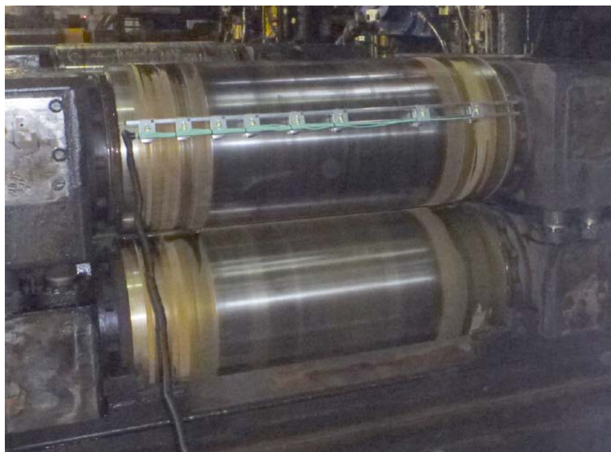
Obr. 14 Měřicí lišta s magnetickými senzory pro měření povrchových teplot válců v provozních podmínkách
