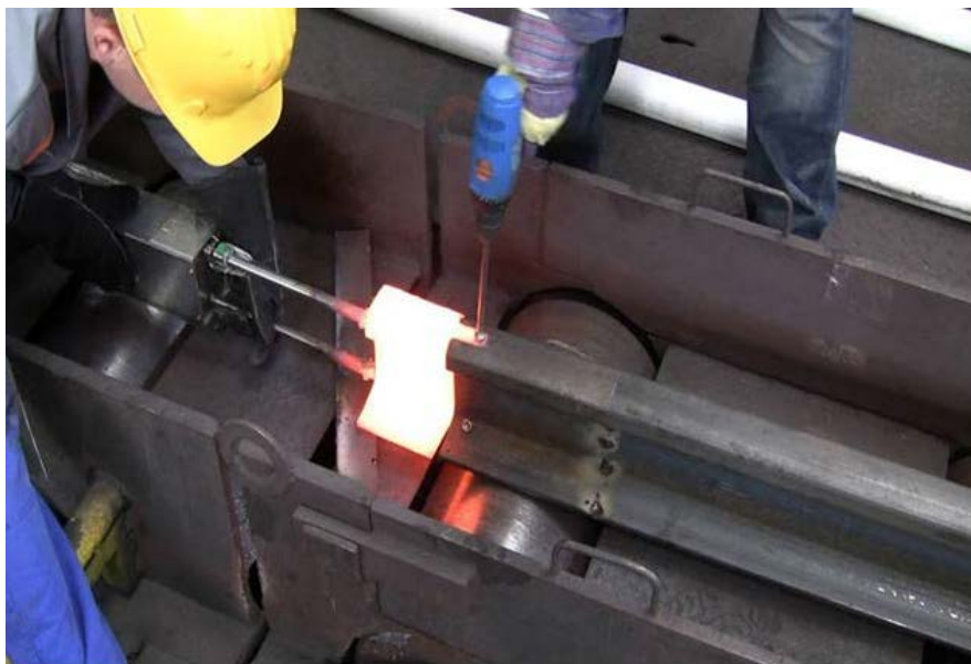
Obr. 24 Segment z austenitické oceli osazený termočlánky napojenými do datalogeru. Poloprovozní měření, vstup do chladicí sekce.
