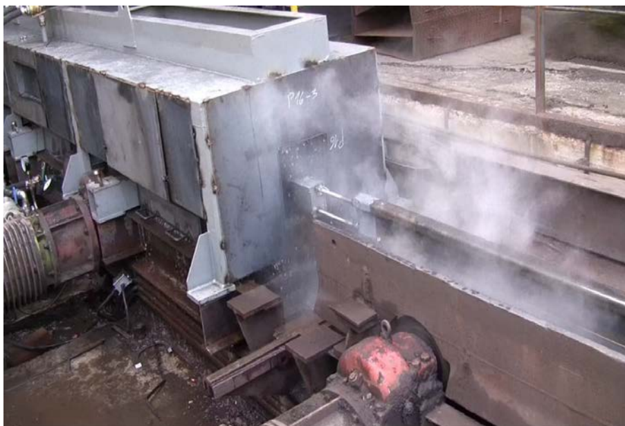
Obr. 25 Segment z austenitické oceli osazený termočlánky napojenými do datalogeru. Poloprovozní měření, výstup z chladicí sekce.
