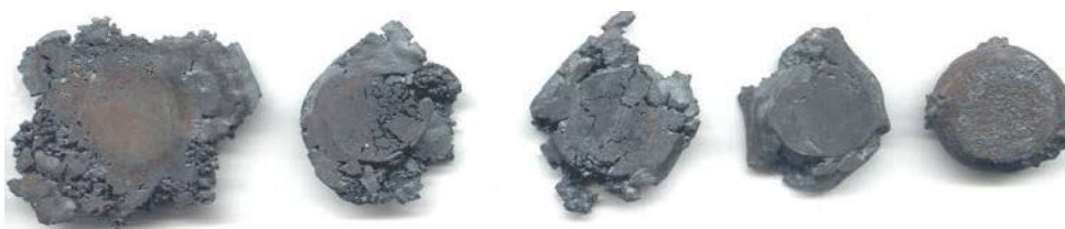
Obr. 9 Válcové vzorky pēchované za různých teplot mezi likvidem a solidem. Původní rozměry vzorku: \varnothing D = 15 \text{ mm} , výška H = 24 \text{ mm} .
