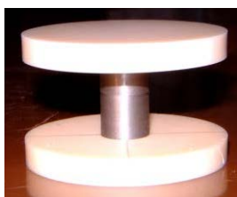
a) Zkušební vzorek mezi korundovými disky.
