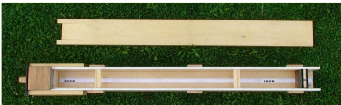
Obr. 3.5 Vyrobená varhanní píšťala, generující základní tón velké C, specificky navržena pro účely validačních měření. Je vybavena demontovatelným víkem, polohovatelnou zátkou a kovovou, stavitelnou spárou, vyfukující vzduch.
