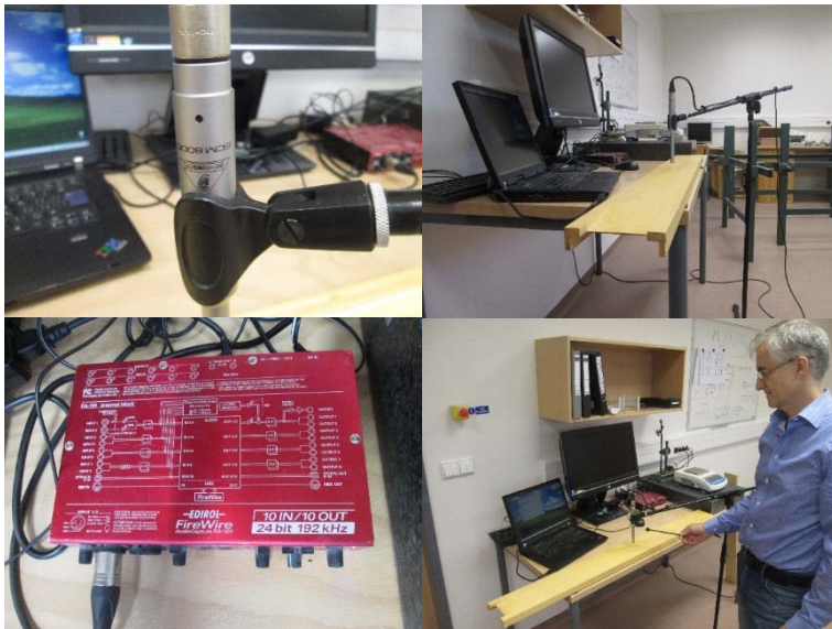
Obr. 4.8 Fotodokumentace z měření logaritmického dekrement útlumu víka varhanní píšťaly pořízená v laboratořích Mendelovy univerzity v Brně.
