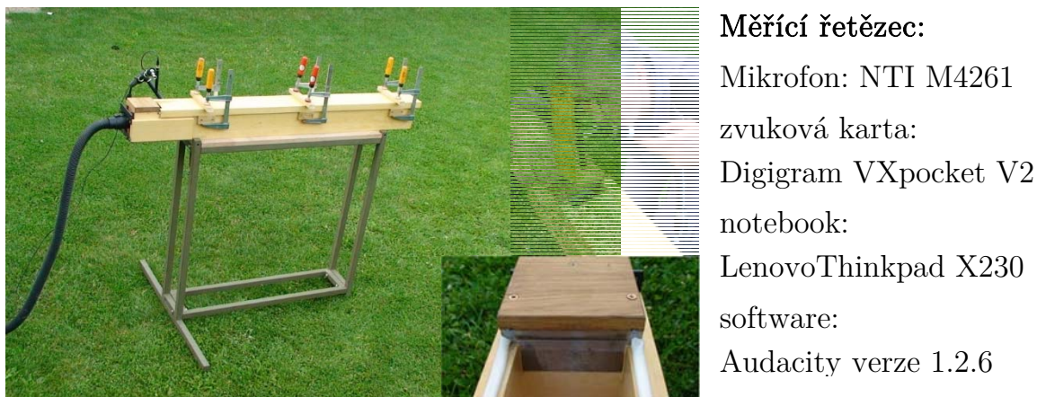
Obr. 3.6 Fotodokumentace z průběhu validačního měření a výzkum vlivu nastavení geometrie konstrukce, které byly prováděny ve venkovním volném prostoru.
