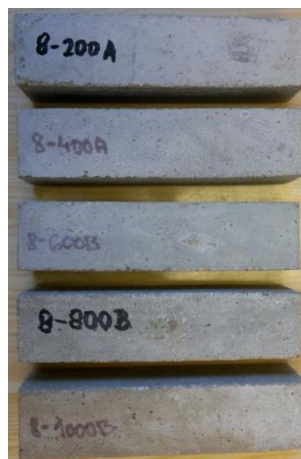
Obr. 4.1b Vyobrazení tepelně namáhaných vzorků betonu o velikostech 40x40x160 mm.
