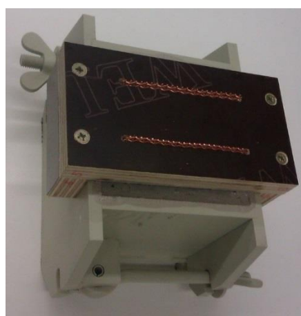
Obr. 7.1b Namíchaná směs ve formě se zapuštěnými elektrodami.
