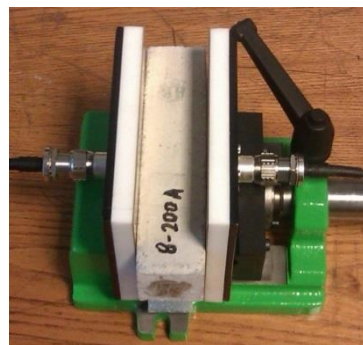
Obr. 2.2b Pohled na přípravek na přiložení deskových elektrod na plátové vzorky různé tloušťky s vloženým vzorkem betonu 4 x 4 x 16 cm.
