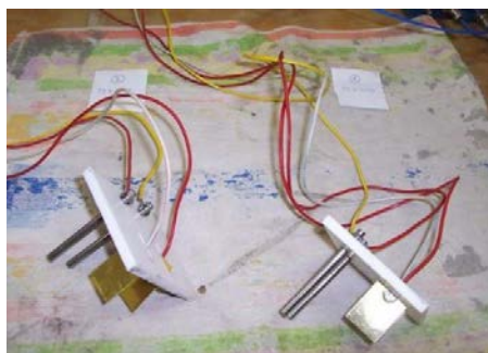
Obr. 3c Pohled na přípravek (včetně elektrod) na uchycení válcových a deskových elektrod vkládaných do čerstvého betonu.
