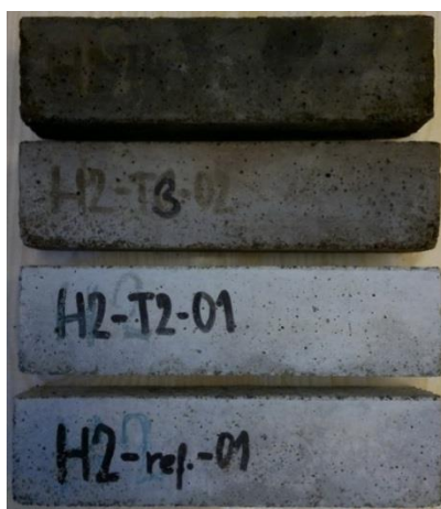
Obr. 5.1a Vyobrazení tepelně namáhaných vzorků betonu s pryžovým granulátem o velikostech 40x40x160 mm.
