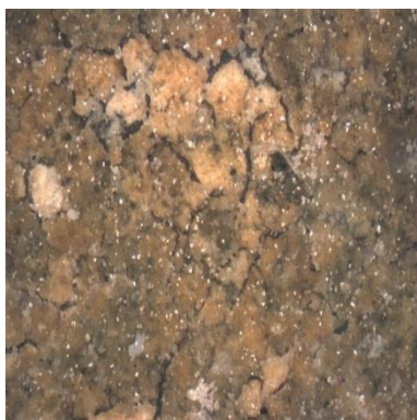
Obr. 4.2g Povrch 1 mm 2 vzorku po namáhání teplotou 1 000 °C.
