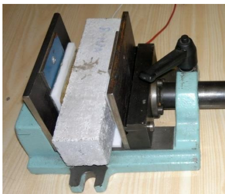
Obr. 4.1a Uchycení testovaného vzorku v přípravku mezi mosazné elektrody o ploše 7x3,5 cm.
