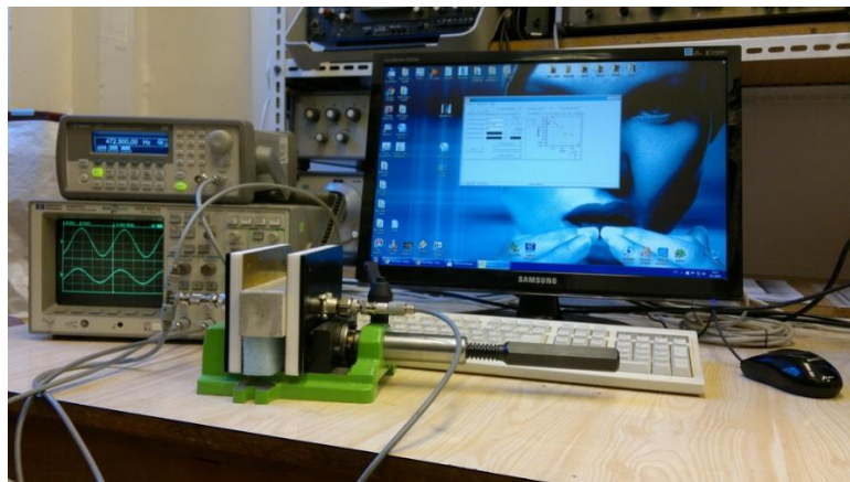
Obr. 5.1e Vyobrazení měřicího pracoviště: zdroj střídavého napětí (RC Generátor Agilent 33220A), dvoukanálový osciloskop, testovaný vzorek, osobní počítač vybavený měřícím softwarem.
