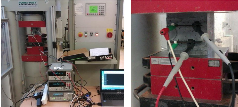
Obr. 7.1d Experimentální uspořádání při zkoušce senzorických vlastností.
