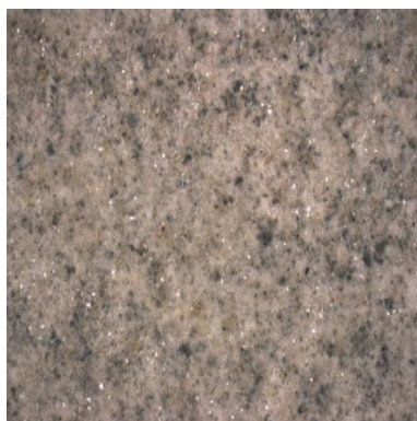
Obr. 4.2e Povrch 1 mm 2 referenčního vzorku, tj. bez namáhání zvýšenou teplotou.
