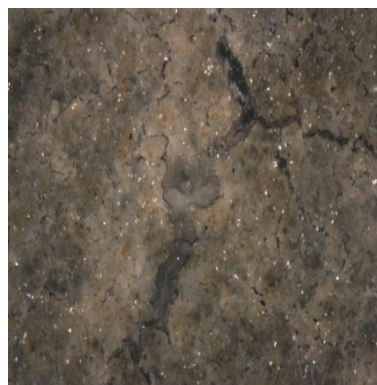
Obr. 4.2f Povrch 1 mm 2 vzorku po namáhání teplotou 600 °C.
