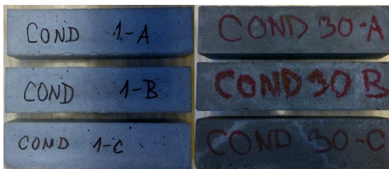
Obr. 6.1a Vyobrazení vzorků s přidavkem grafitu 1 % a 30 %. Velikost vzorků 40x40x160 mm.
