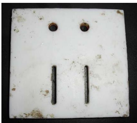
Obr. 3a Celkový vzhled přípravku na uchycení válcových a deskových elektrod vkládaných do čerstvého betonu.
