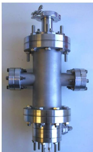
Obr. 11: Aparatura pro experimenty s klouzavým obloukovým výbojem (vlevo) a elektrody s výbojovým kanálem (vpravo).
