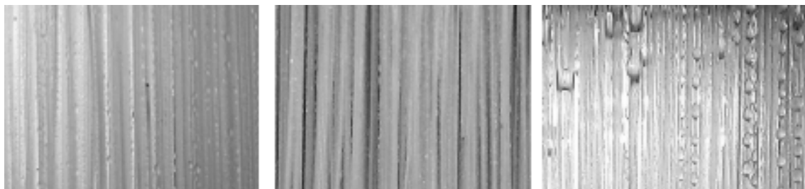
Obrázek 5.3: Vlákna PA výměníku v průběhu experimentu s rychlostí 3 m/s a 50 % relativní vlhkost, vertikální poloha (vlevo), 45° (uprostřed), horizontální poloha (vpravo).
