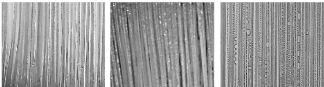
Obrázek 5.6: Vlákna PP výměníku z 20 vrstev v průběhu experimentu s rychlostí 3 m/s a 50 % relativní vlhkost, vertikální poloha (vlevo), 45° (uprostřed), horizontální poloha (vpravo).
