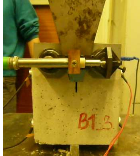
Obr. 5. Zkouška klínovým štípáním – axonometrické schéma (vlevo) a celkový pohled na experiment.
