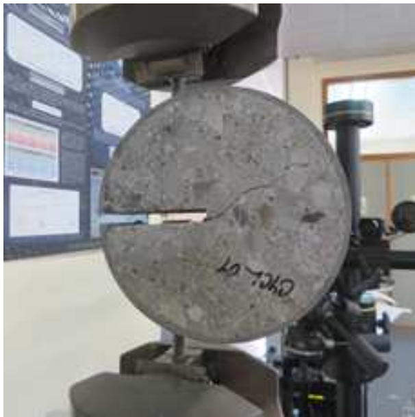
Obr. 12. Zkušební těleso MCT – měřící zařízení: únavový stroj MTS Bionix a optické monitorování deformace pomocí ARAMIS
