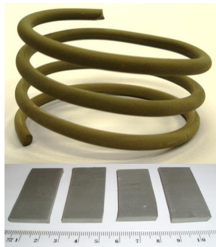
Obr. 7: Pružina a testovací tělíska z MDF kompozitu
