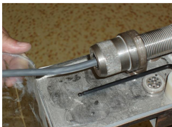
Obr. 6: Vytlačování kulatého profilu jednošnekovým extruderem [48]
