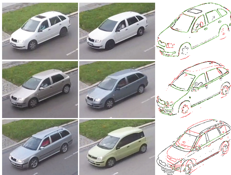
Obrázek 5.4: Cena rozdílnosti mezi vzorky vozidel. vlevo: referenční vozidlo, uprostřed: srovnávané vozidlo, vpravo: vizualizace rozdílnosti hran (černě: referenční vozidlo, zeleně: pixely srovnávaného vozidla se shodou, červeně: pixely srovnávaného vozidla bez shody).
