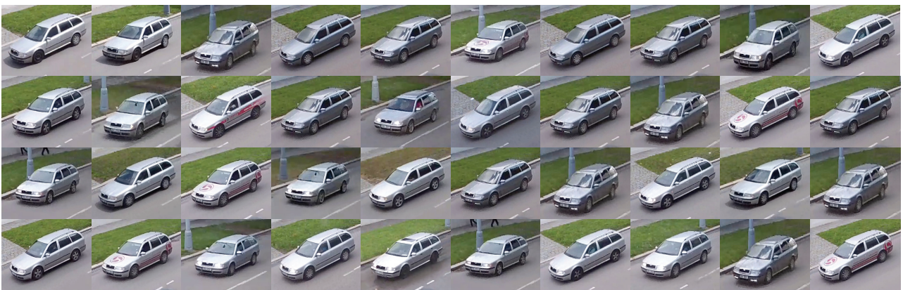
Obrázek 5.7: Příklad jednoho shluku získaného navrhovaným algoritmem. Shluk byl získán při \tau = 0.38 , což znamená, že vzorky vozidel jsou si výrazně vizuálně podobné – například mají pouze světlé barvy (šedou, stříbrnou, bílou). Pro vyšší hodnoty \tau obsahují uzly větší výběr barev (jako v obrázku 5.1). Opakované pozorování stejného vozidla je způsobeno tím, že stejné vozidlo projelo silnicí vícekrát.
