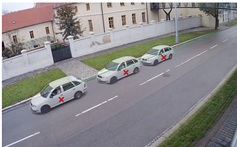
Obrázek 5.2: Akvizice vzorků vozidel. Dohledová kamera sleduje pohyblivá vozidla (zelená čára vyznačuje jednu trajektorii vozidla). Několik pozic v obraze (typicky 3) je manuálně vyznačeno (červené křížky) a pozice vozidla, které s nimi korespondují, jsou vybrány na základě pozice středu podstavy jejich obalového kvádrů (kapitola 4.2).
