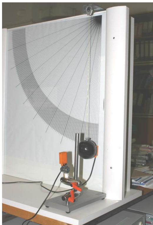
Obr. 12: Pohled na realizaci klibračního zařízení při měření doby kyvu
