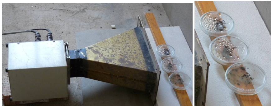
Obr. 8) Aplikace EMWR na vzorky plísní [28]
