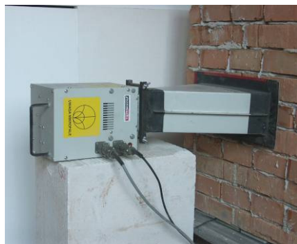
Obr. 7) Schematický obrázek a foto EMWR zařízení s trychtýřovou anténou
