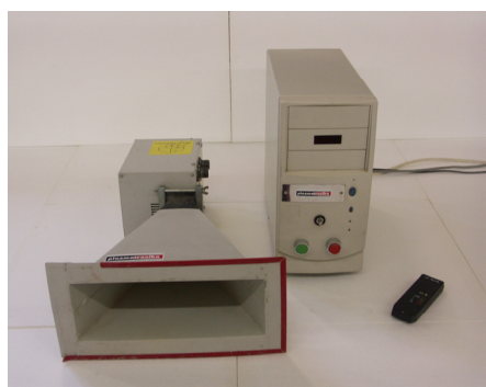
Obr. 7) Schematický obrázek a foto EMWR zařízení s trychtýřovou anténou
