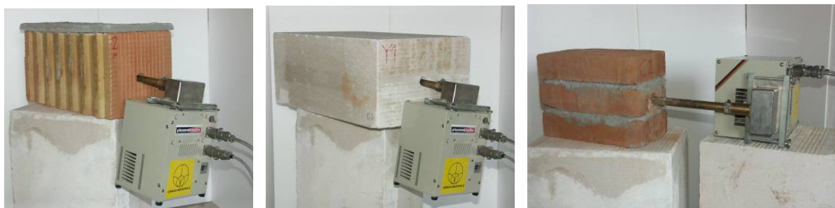
Obr. 4) Způsob vysoušení pomocí EMWR se zásuvnou tyčovou anténou [18] [20] [19] [24]
