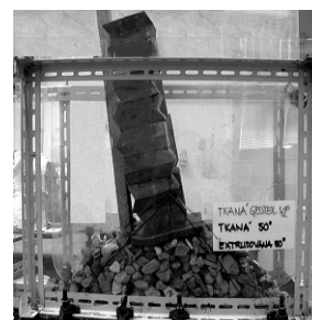
geotextilie – porušení (8 kostek \approx 0.6 kN)
