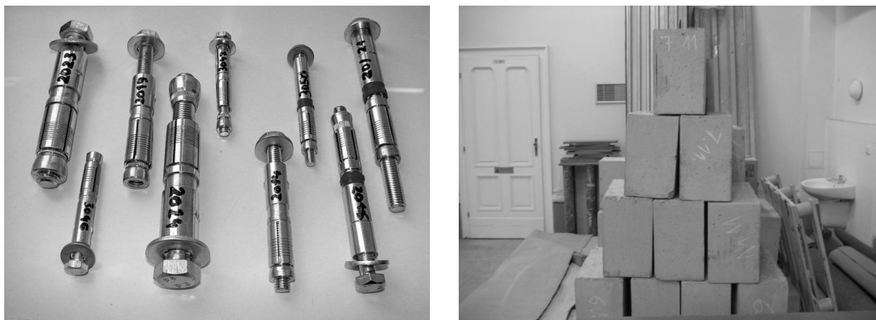
Obr. 4.02 Testované kotvy (KOTE – HA) a betonová zkušební tělesa
