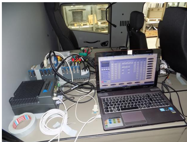
Obr. 9 Implementovaný hardware v prototypu vozidla pro HIL testování
