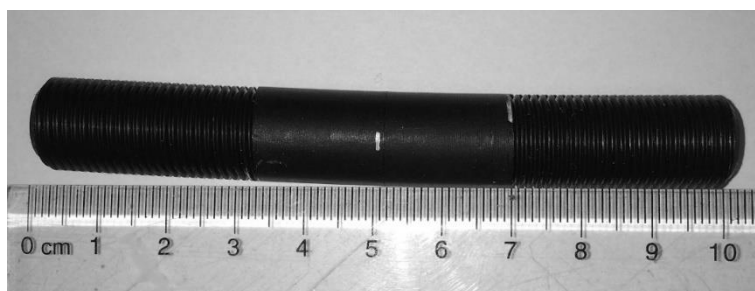
Obr. 10 – Fotografie CRB vzorku, který byl vyroben soustružením hranolu vyříznutého ze stěny PE trubky. Deformace je způsobena reziduálním napětím
