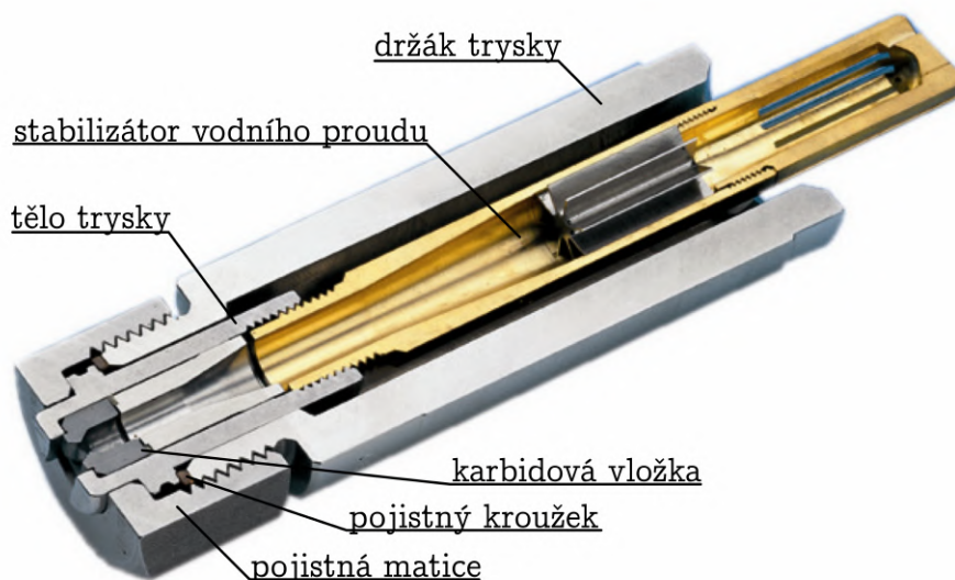
Obrázek 2.2: Konstrukce trysky [8]
