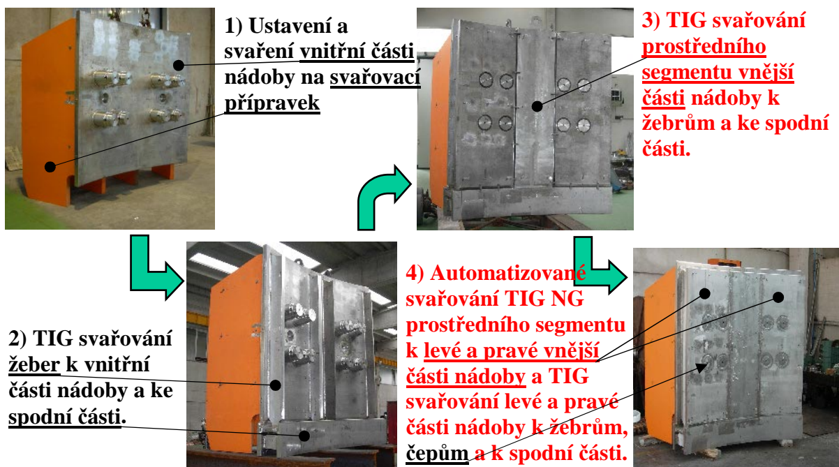
Obr. 5.2 Postup svařování části PS1
