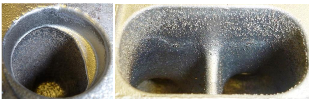
Obr. 4 Sací a výfukový kanál odlitku naftové hlavy válců s nalepeným ostřivem po odjadrování
