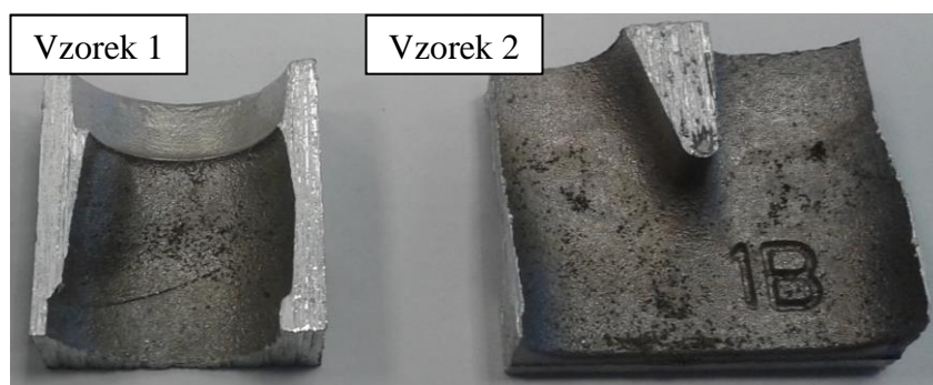
Obr. 9 Vzorky z odlitku s nalepeným ostřivem v sacím a výfukovém kanále
