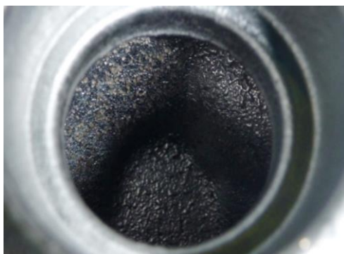
Obr. 11 Vzorek z odlitku s nalepeným ostřivem v sacím kanále
