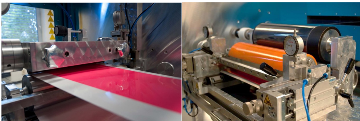
Obr. 17 Tisk dozimetrů dvěma různými technikami: štěrbinové nanášení (Slot Die) vlevo a válcové nanášení.
