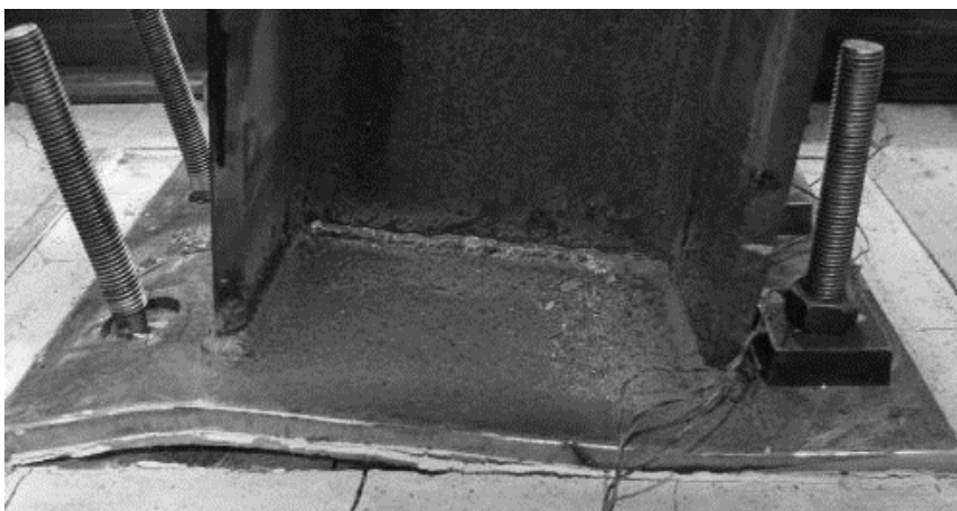
Obr. 2.5: Deformovaný patní plech a kotevní šrouby – experiment, rovinný ohyb
