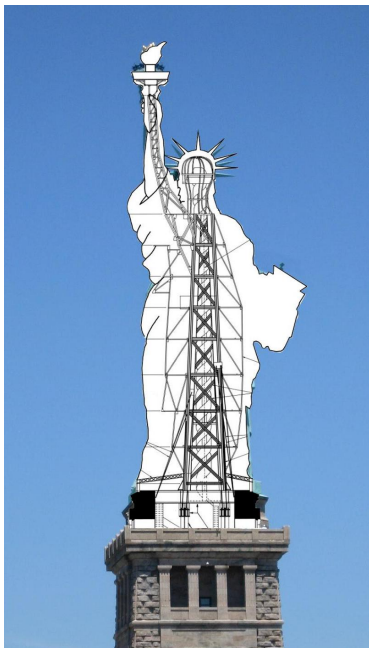
obr. 6 příhradová nosná konstrukce Sochy Svobody
