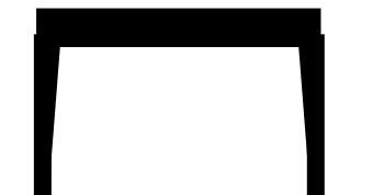
u jednoduchých staticky určitých případů. Velikosti ohybových momentů klesají na polovinu obr. 13 vliv spojitosti rámu na průběh momentu s následným efektem tvarování prutu
